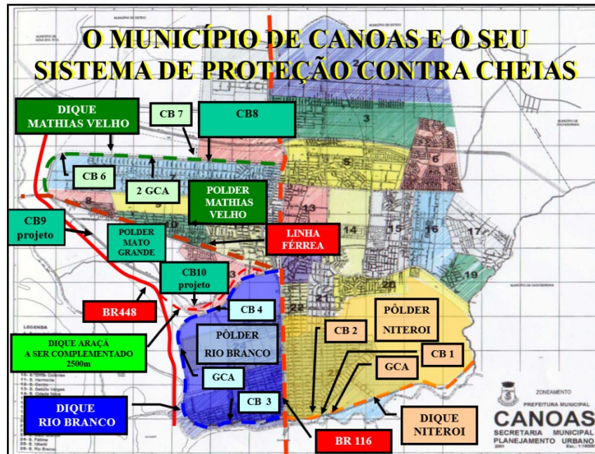
Figura 6: Sistema de proteção contra cheias
