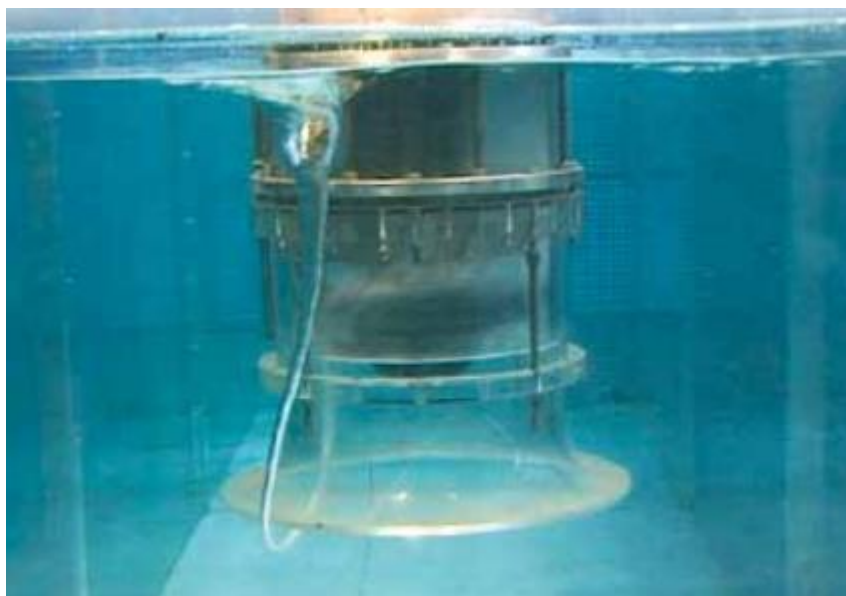
Figura 20 - Avaliação de vórtices no ensaio físico em escala reduzida
